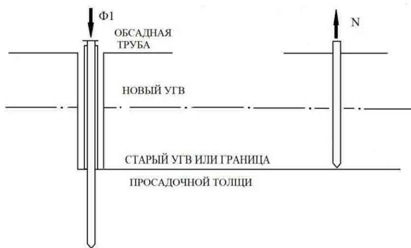
Рисунок Б.3 – Схема расположения сваи в грунте: УГВ ниже границы просадочной толщи (обводнение)
