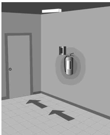
Рисунок 5.8 – Расположение светильника эвакуационного освещения возле пожарной кнопки и огнетушителя
