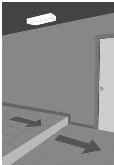
Рисунок 5.3 – Расположение светильника эвакуационного освещения в месте изменения уровня пола
