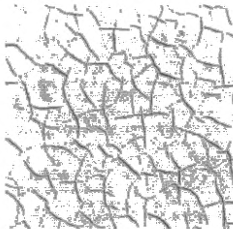
Рисунок 3 — Образование средних трещин лакокрасочного покрытия
