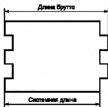
Рисунок А.1 — Размеры изделий с пазогребневым соединением
